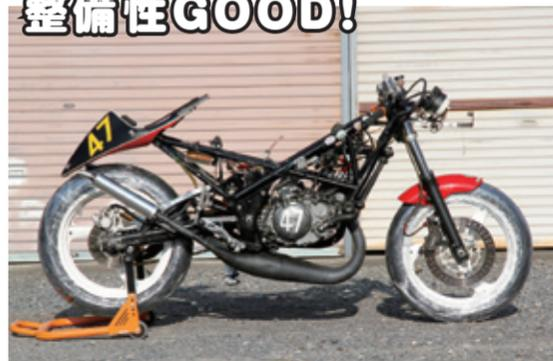
エリア47の藤井代表が力説していたのがRZ、RZR、R1-Zといったヤマハ車の整備性の良さ。可動式シートカウルで電装系を整備しやすく。
