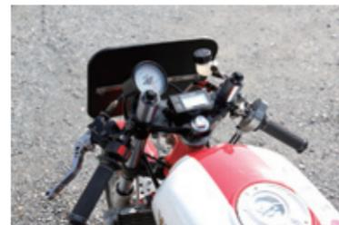
TZ用セラートハンドルを片側300gずつ軽量化して装着。フロントフォークはRZだとφ32mmで流石に細すぎるのでφ35mmのRZR用を使用。
