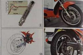
⑥フロントフォークはリニアブルダンパーを採用。伸び抑制の減衰力を強化し、余計な動きを防ぐ。⑦フレームキャリアバーはR2が押針式ビス固定だったのにに対し、R1/R2/R3-RFはディスクの両側から挟み込む対向式に。制動力がアップしている。⑧フロントフォークが捻られず確実に伸び縮みするように、ストラッパーを装備。⑨@リヤフレームキヤウドは油圧アクシス式で、リアサスはボルムリンク式の「ニューモノクロスサスペンション」。⑩ステッキ位置はR2よりも後退し、ヨーリレーシー。⑪メーターポディヤミラーもフレームマウント。セバート・レントン（ドル）はアルミ製。⑫タコマーターがセンターボーに位置。
